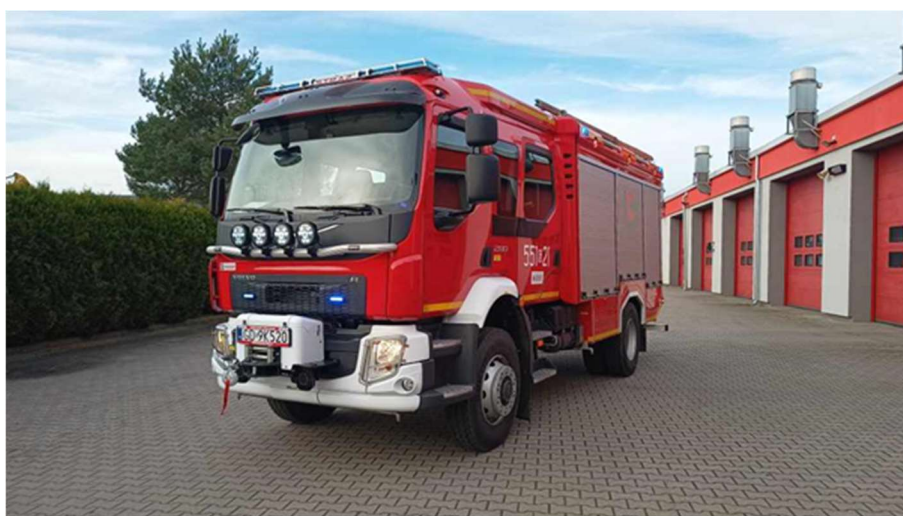
Zdjęcie. Zakupiony Średni Samochód Gaśniczy 2,6/30 na podwoziu Volvo FL.
