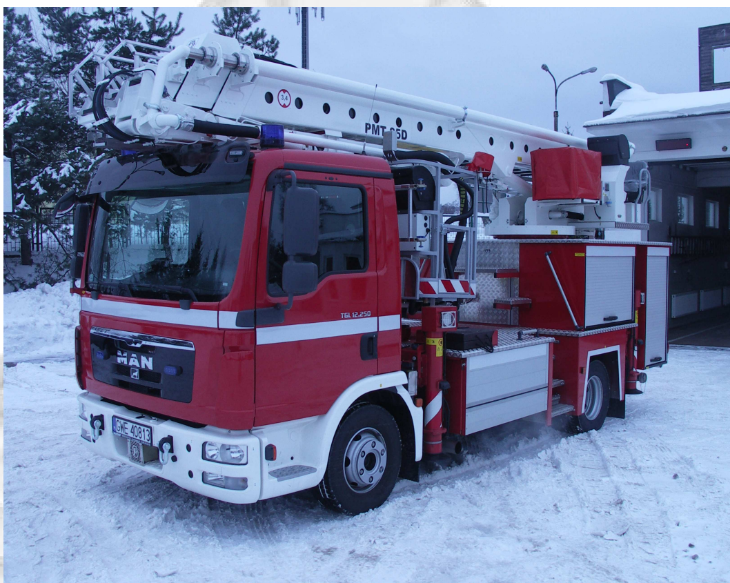
Samochód ratownictwa wysokościowego: samochód z podnośnikiem o wysokości ratowniczej 23 m (SHD-25) MAN TGL.
